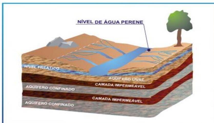
Figura 2. Tipos de aquíferos quanto à pressão.
