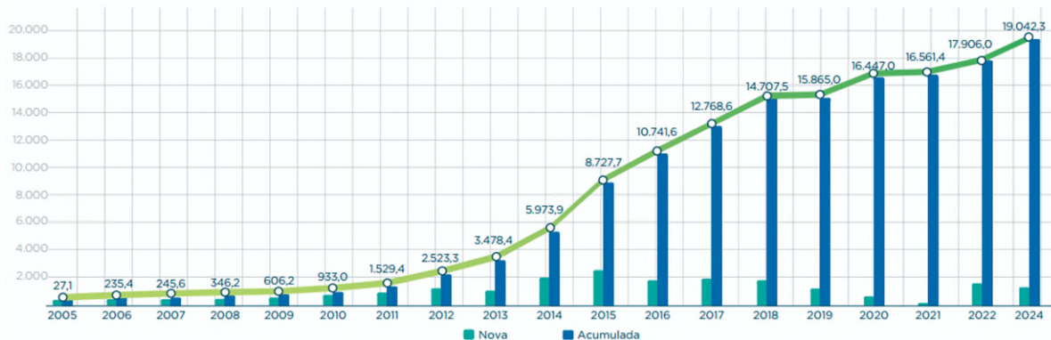
Figura 3: Evolução da capacidade eólica instalada no Brasil, em MW, entre 2005 e 2019 e valores previstos até 2024. (Fonte: ANEEL/ABEEólica, 2019)
